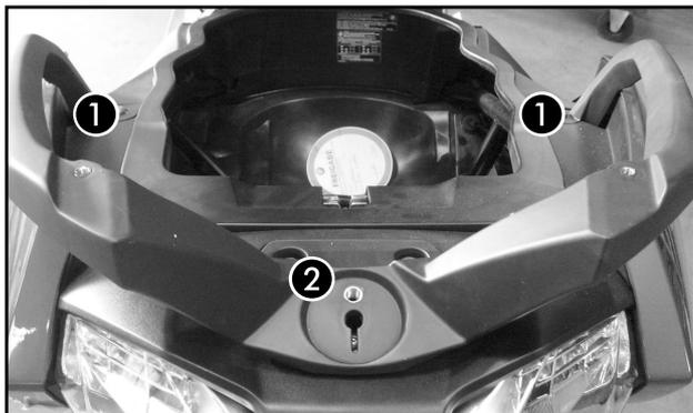
Die Kunststoffstopfen in den Haltegriffen entfernen um die Gewinde M6 freizulegen. ①
