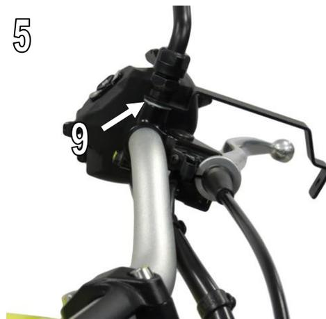
5. Montieren Sie den rechten Halter (3) mit der Schraube und Mutter vom originalen Handschutz wie in Abb. 6 gezeigt / Fit R/H bracket (3) using original bolt and nut from hand guard as shown in Fig.6
