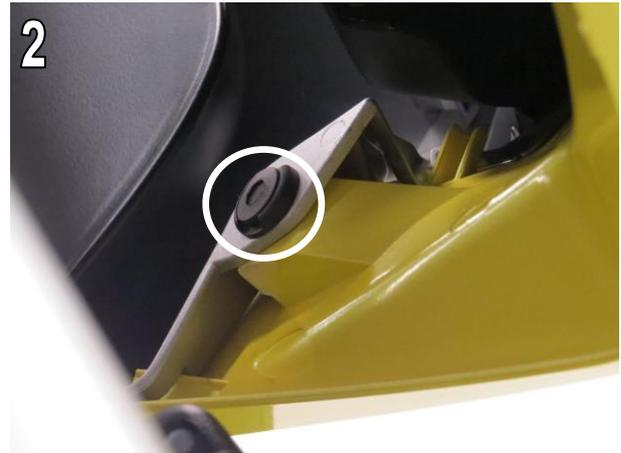
4. Entfernen Sie die Torx-Schraube, damit die untere Scheinwerferverkleidung entfernt werden kann. Abb. 3 / *Remove torx screw indicated to allow under headlight panel to be removed. Fig.3*
