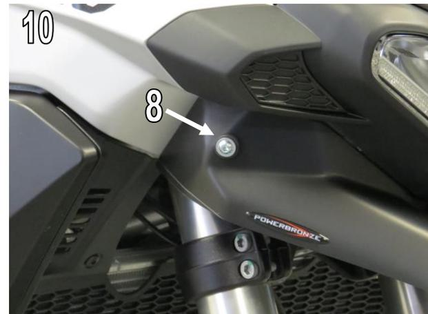
**WICHTIG: Überprüfen Sie regelmäßig die Ausrichtung des Schnabels und die Spannung der Befestigungsschrauben. / IMPORTANT: Always check alignment of beak and mounting bolt tension periodically.**
