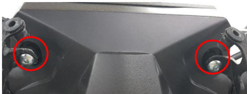
3. Montieren Sie die Halter wie unten gezeigt, indem Sie die 2 Kunststoff-Distanzen 6x10mm zwischen Instrumententafel und den Haltern einsetzen und anhand der 2 Originalschrauben unten und der 2 Inbusschraube M5 x 20mm oben verschrauben. Der untere Teil der Halterung muss zwischen den schwarzen Seitenteilen und den grauen Streben der Scheinwerferverkleidung platziert werden.
