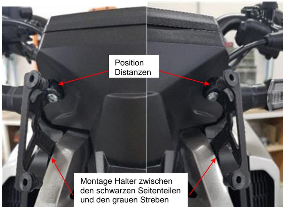
4. Legen Sie nun die silberne Scheinwerferverkleidung an die Halter an und verschrauben Sie diese mittels 4x M5x20mm Inbusschraube und Kunststoff-U-Scheibe an den Haltern.
