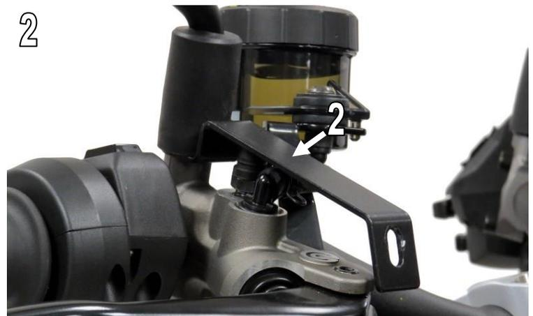
5. Montieren Sie die Lenkerendeneinsätze am linken Handprotektor. Ziehen Sie die Schraube zu diesem Zeitpunkt noch nicht fest Abb.3 / *Fit bar end assembly to left hand guard. Do not tighten up the screw at this stage Fig.3*
