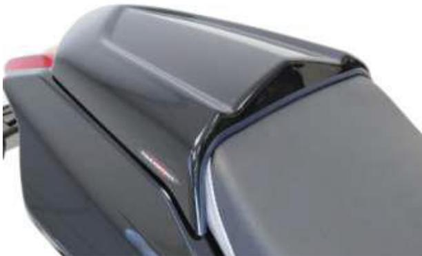
3. Stellen Sie sicher, dass der Sitzkeil komplett über der Sitzbank ist. Biegen Sie die Metalclips so nach Innen, dass ein sicherer Sitz gewährleistet ist. Passen Sie auf, dass der Sitzbezug nicht von den Metalclips beschädigt wird. / Ensure seat is fully located backwards into the seat cowl. Adjust metal clips for a snug fit. Be careful to ensure metal clips do not damage seat upholstery.
